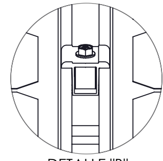
DETALLE "B" NXT-AUA Abrazadera Universal (Modo Intermedio)
